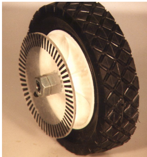
Figura 4: Encoders, permiten estimar la posición del robot
