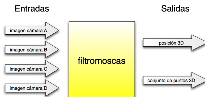
Figura 5.1: Representación del esquema filtromoscas como caja negra.
