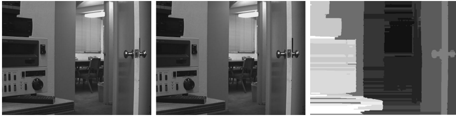
Figura 1.9: Mapa de disparidad. La imagen original se encuentra a la izquierda y el mapa de disparidad general está a la derecha. El color de la imagen de la derecha representa la profundidad de cada punto. La imagen pertenece a [BT99].
