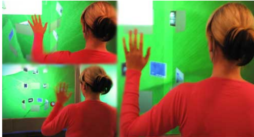
Figura 1.10: Interfaz hombre-máquina GoMonkey usando visión. El usuario mueve sus brazos para controlar la interfaz de ventanas mostradas.
