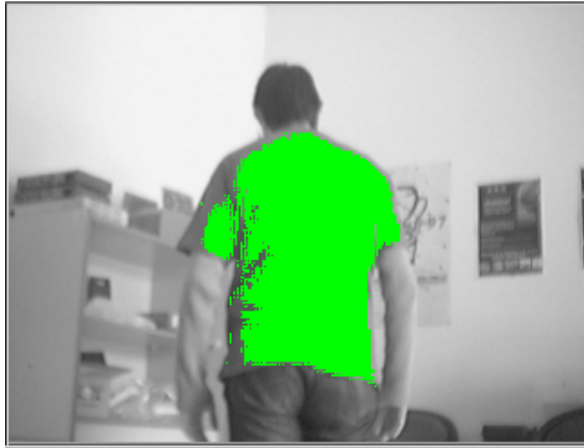
Figura 4.5: Ejemplo de la imagen tras aplicar el filtro HSI
