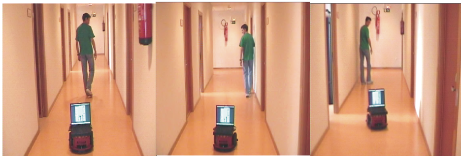
Figura 4.17: Ejemplo de seguimiento por un pasillo
